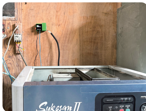
生産管理システムと連携し、終業時にIoTで電源制御を行い、「Arduino」から電源管理を間接制御
