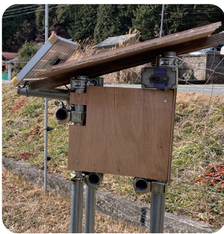
自家発電機付きカメラで水田の様子をリモート監視し、遠隔で水門を開閉する
