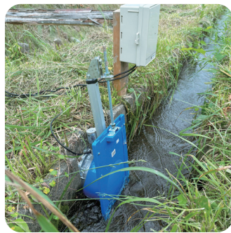
自家発電機付きカメラで水田の様子をリモート監視し、遠隔で水門を開閉する
