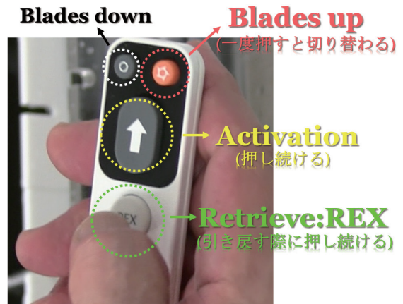
図 2) Jetstream コントローラー
